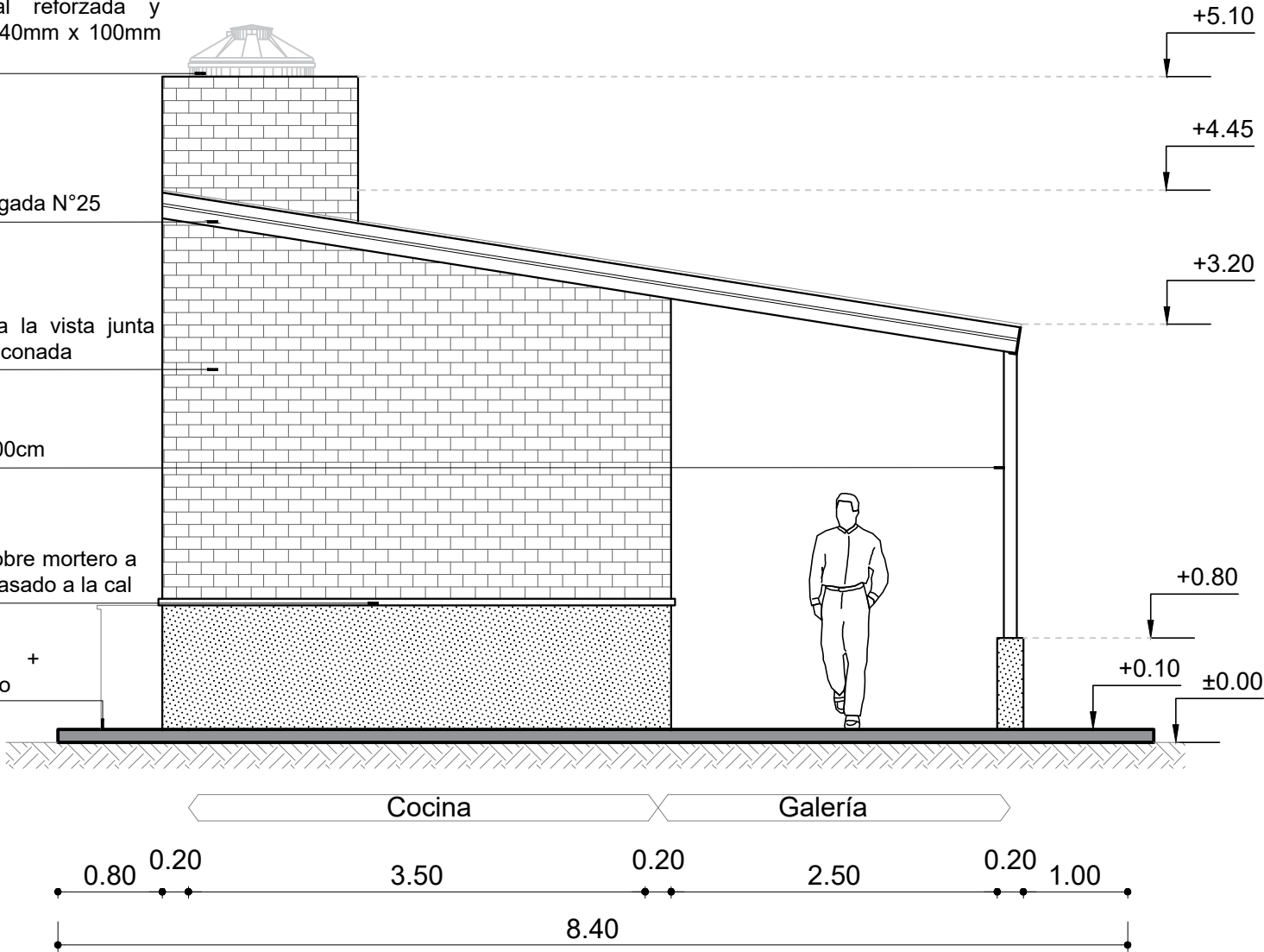
FACHADA LATERAL Esc. 1:50
